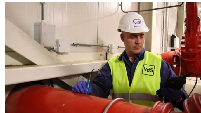
De wanddiktemeting wordt uitgevoerd met ultrasonore apparatuur
