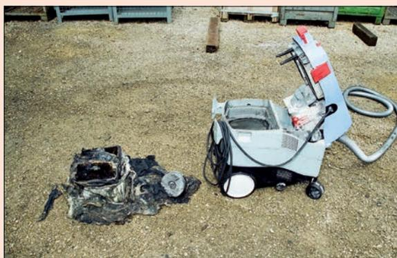
*Links die Situation im metallverarbeitenden Betrieb, rechts der zerstörte Nass/Trockensauger neben einem baugleichen intakten Exemplar*
