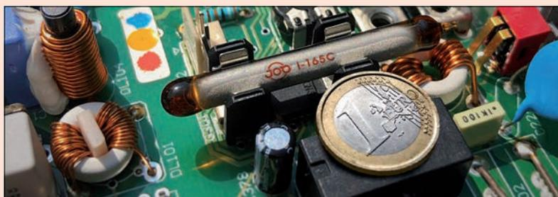
Löschvorrichtungen lassen sich heute direkt im Gerät unterbringen. Hier die E-Bulb von Job auf einer Platine (Foto: JOB GmbH)
