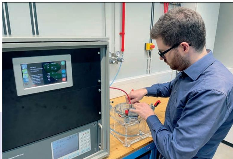
*Die CO-Melder mussten diverse Tests bestehen, bevor eine Anerkennung ausgesprochen werden konnte (Foto: VdS)*
