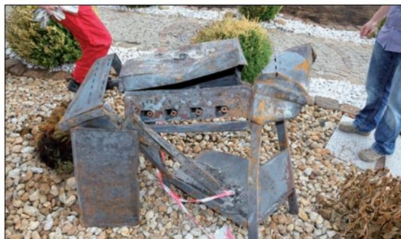
störung und des Fehlens der Gasflasche kann die eigentliche Schadenursache jedoch nicht weiter eingegrenzt werden. In jedem Fall ist der Brand im Bereich des hölzernen Balkons an einem dort aufgestellten Gasgrill entstanden und wurde durch direktes Beflammen brennbarer Materialien ausgelöst. Der Brand griff daraufhin auf das Gebäude über.
