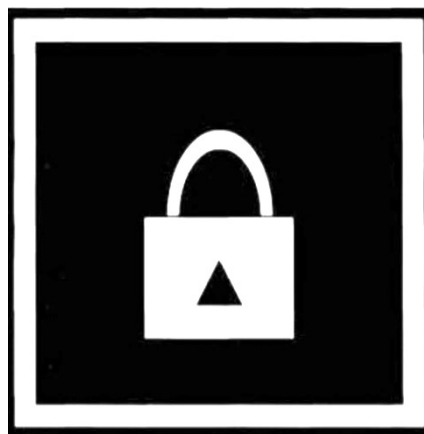
Figuur 13.5 Pictogram indien de noodontgrendeling elektrisch bekrachtigd is Bron: Figure C.1 uit de NEN-EN 81-71:2022 is overgenomen met toestemming van de NEN te Delft
