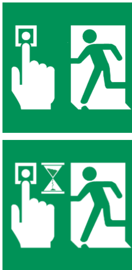
Figuur 15.4 Systeem zonder en met tijdvertraging Bron: Figure 2 uit de NEN-EN 13637:2015 is overgenomen met toestemming van de NEN te Delft
