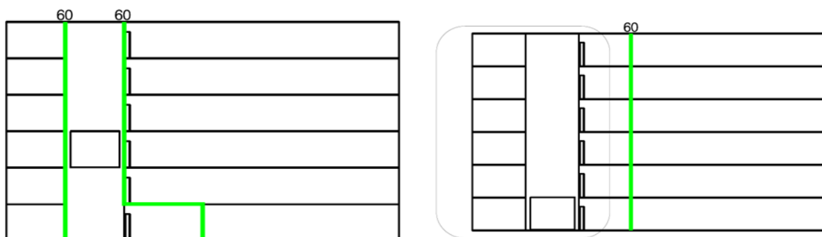
Figuur 13.4 Mogelijke uitvoering brandcompartimentering Bron: NEN-EN 81-72
